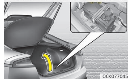
■ Панель предохранителей аккумулятора
